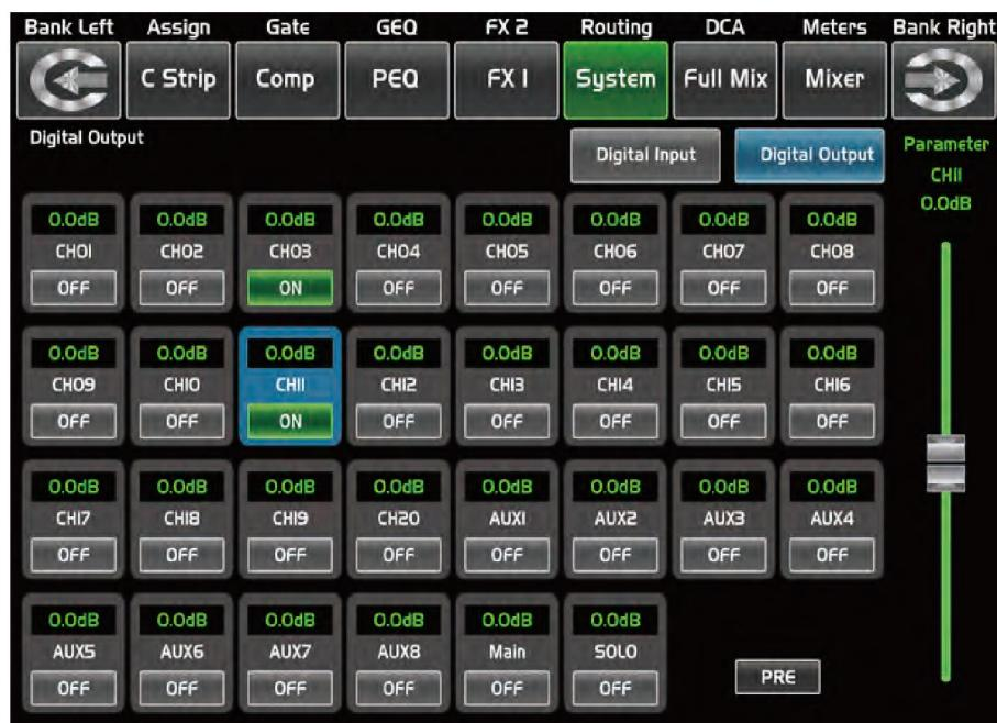
Cuando se selecciona un canal con salida en la casilla correspondiente la palabra "OFF" cambiará a "ON" y la misma se iluminará, indicando que el canal seleccionado tiene una salida digital.
