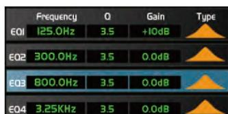
Al tocar alguna de las bandas (EQ1, EQ2, EQ3, EQ4) se activará la posibilidad de ajustar cualquiera de los tres parámetros de dicha banda, Frecuencia, "Q" y ganancia, también se podrá cambiar el tipo de filtro entre paso-alto, paso-bajo o pasa-banda. La curva se podrá observar en la cuadricula de la pantalla.
