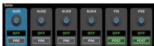
Toque AUX1-4 y FX1-2 en la pantalla LCD o presione el botón correspondiente en el panel para asignar canales de entrada de audio a estos buses. Para ajustar el nivel de salida del canal de audio, se puede girar la perilla de ajuste de parámetro en el panel.
