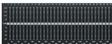
En esta pantalla, se puede ajustar la ganancia de cada frecuencia en específico, tales como frecuencia y ganancia. El valor de ajuste se mostrará en la pantalla por debajo de la curva del gráfico. Por favor, siga las instrucciones que se muestran en la pantalla LCD para ajustar los diferentes valores.
