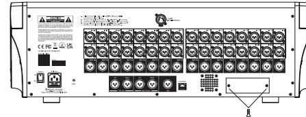
2). Disassemble the Module from MIXER.
